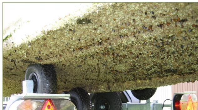
Bilden visar en båt vars botten är täckt av havstulpan, som är den mest dominerande och svåraste påväxtarten.
