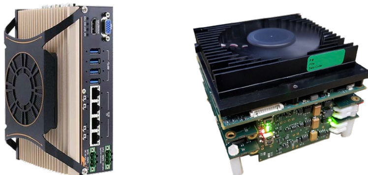
Figur 8. Utvecklingsprodukter för iX10 serverfamiljen. Vänster: iX10-ADS för SpaceCloud app-utveckling. Höger: iX10-100 EM för verifiering i satellitintegration.
