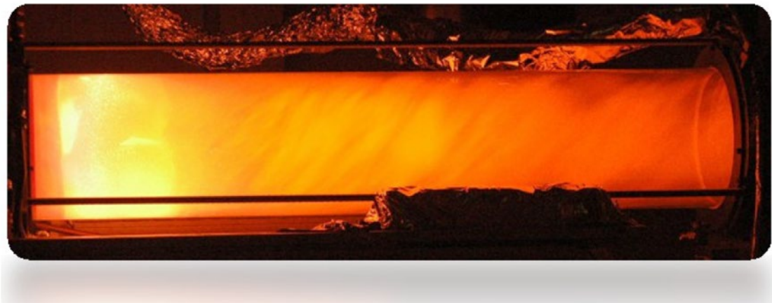
Figur 15: Bild på en naturgasflamma med 40% vattenånga i utvecklingsriggen vid TU Berlin.
