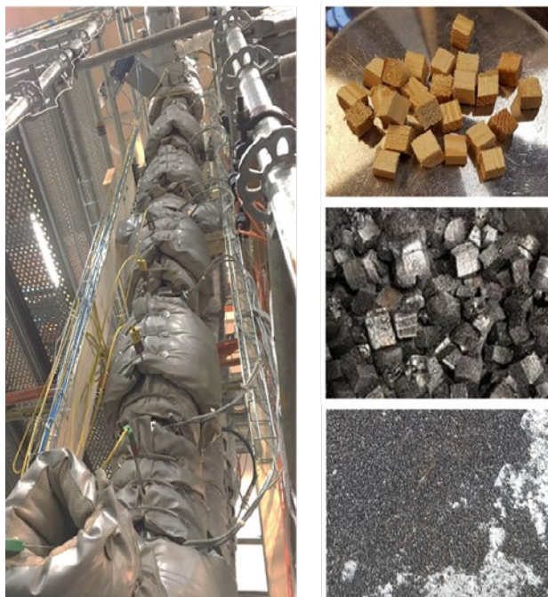
Figur 13: Bolagets utvecklingsrigg för laddningsprocessen (vänster) och hur bränslet omvandlas från rå biobränsle till biokol efter laddning som kan enkelt malas till ett pulver (höger)
