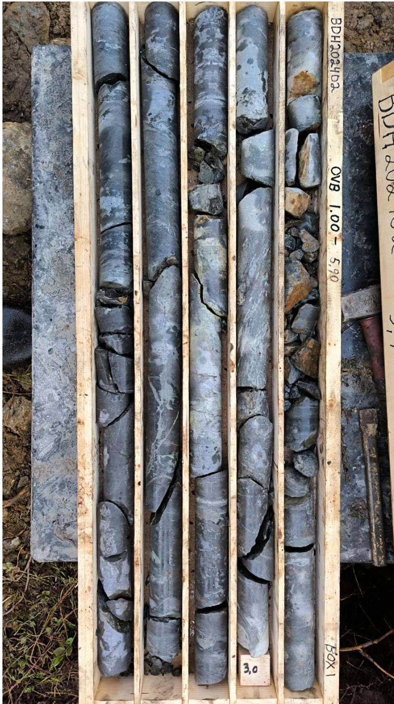
Borrkärnor från pågående kärnborring i Stortjärnhobben
