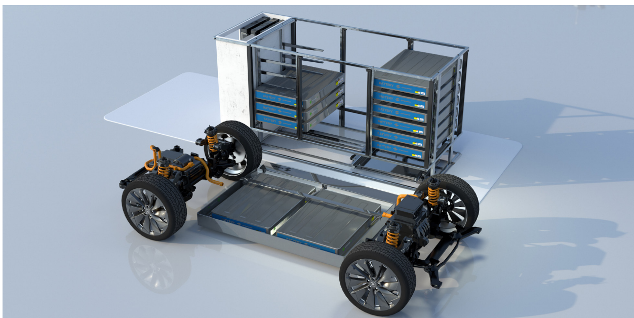
Power Swap-enhet i genomskärning med batterier på lager
