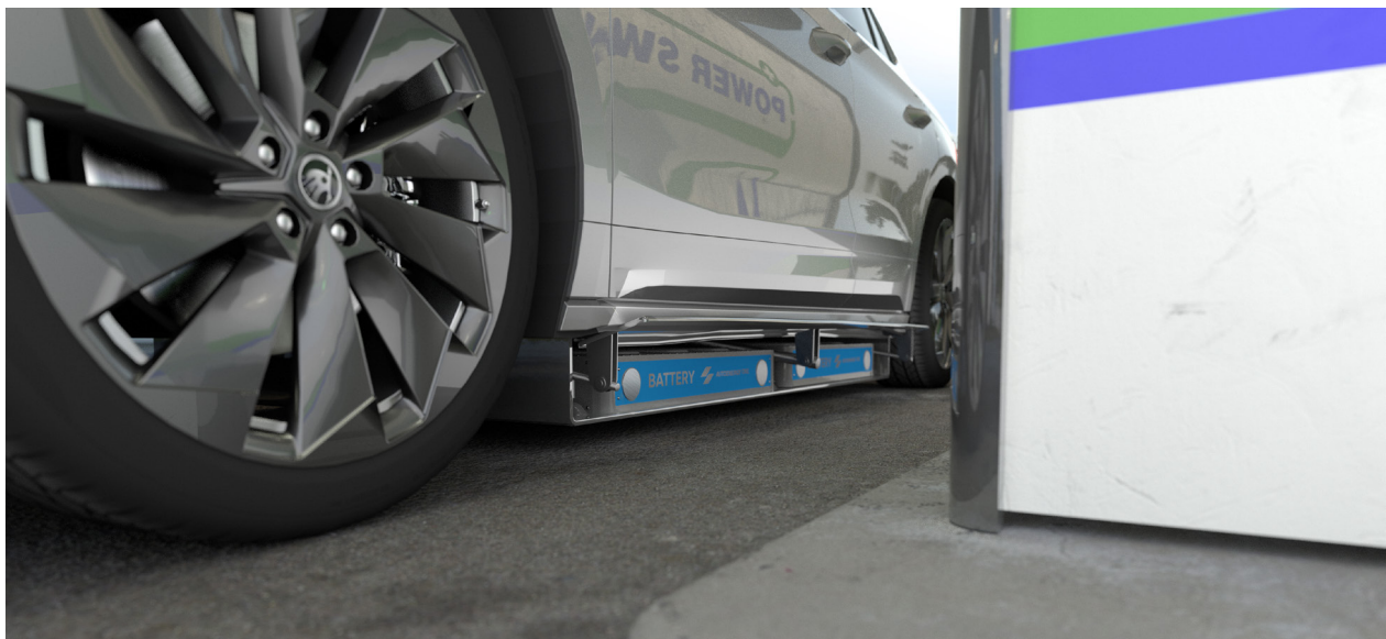
Power Swap-kompatibel bil som initierar byte av batterier. Kassetten sänks ner innan bytet görs.
