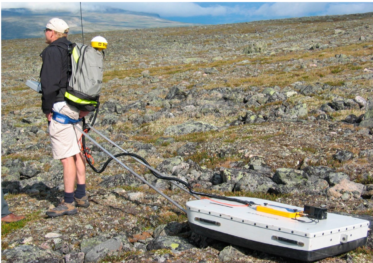
Ett s.k. X3M-system som används för att undersöka markförhållanden i norra Sverige
