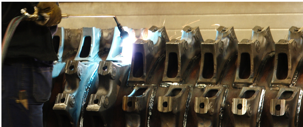
Svetsning vid tillverkning av Countermines grovverktyg vid företagets verkstad i Södertälje
