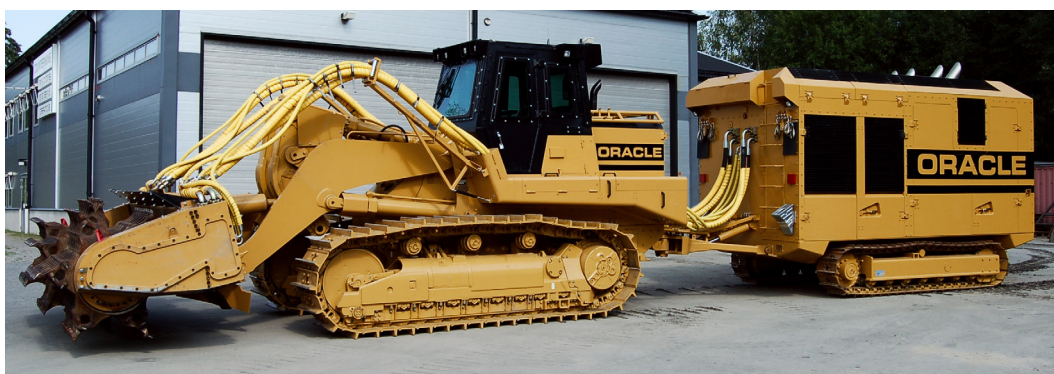
ORACLE-systemet består av minsaneringsverktyget (här med grovverktyget monterat), själva bandmaskinen och ett aggregatslöp
