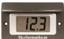
Bilden ovan visar Skyllermarks egen voltmeter. För blybatterier gäller att spänningen direkt visar laddningstillståndet. Instrumentet ovan visar 12,3 V, vilket betyder att batteriet är halffullt. Skyllermarks skickar alltid med en översättningstabell med sina voltmetrar.
