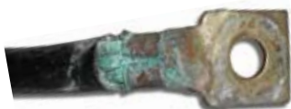
I många gamla äldre båtar ser kablar ofta ut som bilden ovan. Det gröna på bilden är kopparoxid som är en isolator som hindrar strömmen från att komma fram. Skyllermarks kablar är förtenta och pressade med dubbelglödade rörkabelskor varför ovanstående inte händer med Skyllermarks färdigpressade kablar.
