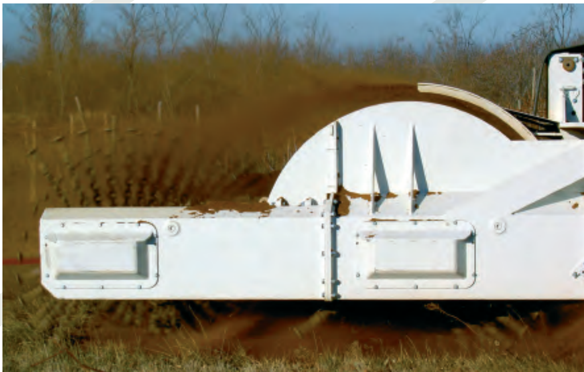
Scanjack 3500 minröjningsaggregat med dubbla roterande valsar, s k double flail system.
