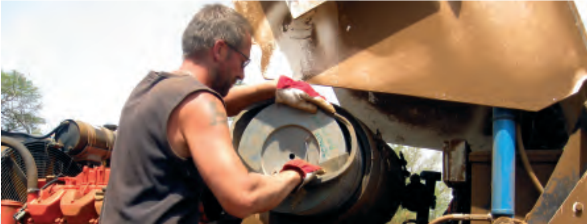
Byte av luftfilter, Sudan 2008.
