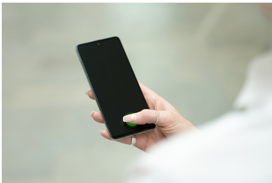
Bildtext: Illustration av fingeravtrycksteknologi i en smartphone. Användaren identifierar sig och ges tillgång till mobiltelefonen och dess tjänster med hjälp av sitt tumavtryck. På bilden läses fingeravtrycket av en optisk eller ultraljudssensor som monterats under telefonens display.
