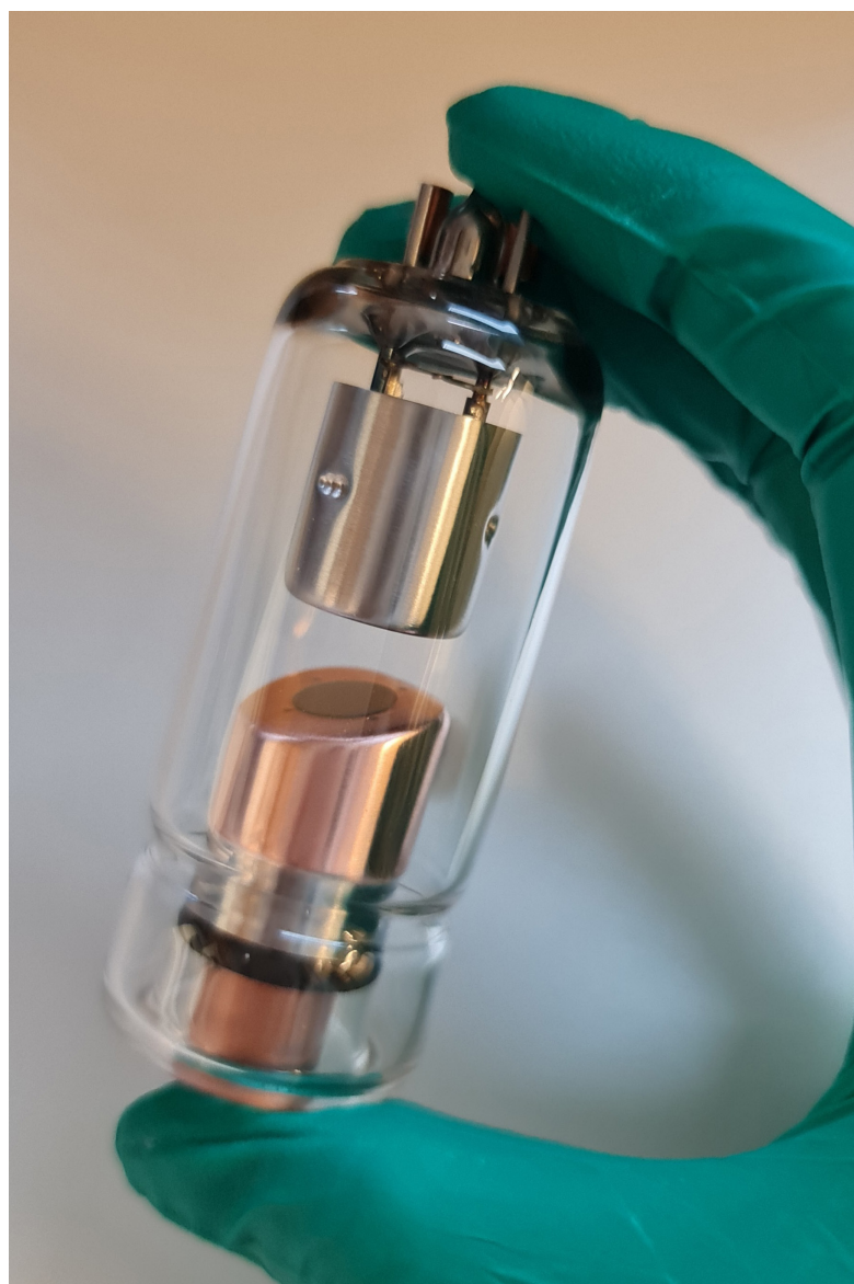
Prototyp av Luxbrights kallkatodrör tillverkad i december 2021.
