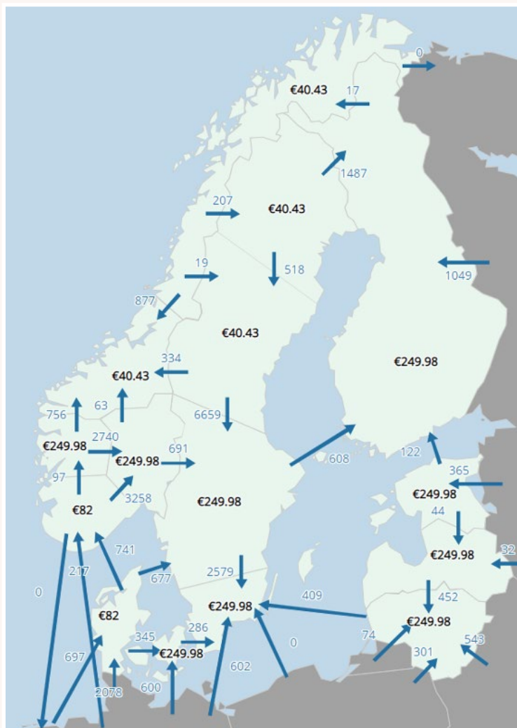
Figur 18: Urklipp från Svenska Kraftnät och Kontrollrummet 2021-01-08 som visar på de stora prisskillnaderna mellan norr och söder är det är kallt och det inte blåser.
