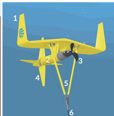
Bild 4. Minestos marina kraftverk Deep Green består av en vinge ( 1 ), som bär upp ett maskinhus (nacelle) ( 2 ). Framtill i maskinhuset sitter turbinen ( 3 ) som är kopplad till en generator. I den bakre delen av maskinhuset finns kraftverkets styr- och kontrollsystem. Med hjälp av roder ( 4 ) styrs kraftverket automatiskt i en förutbestämd bana. Stagen ( 5 ) är kopplade till en förankringslina ( 6 ) som kopplar kraftverket till en förtöjningspunkt fäst i ett fundament på havsbotten. Förankringslinan rymmer elkablar såväl som kablar för kommunikation. Källa: Minesto
