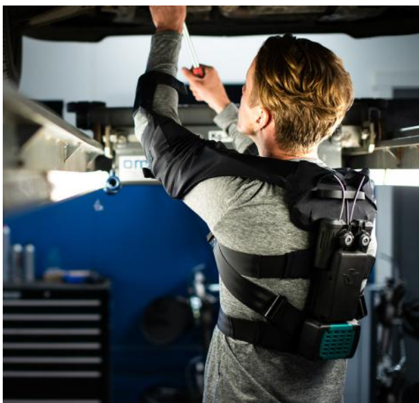
Ironarm® är ett aktivt exoskelett för ergonomiskt stöd för armar och axlar vid arbete i utmanande vinklar. För närvarande under utveckling.
