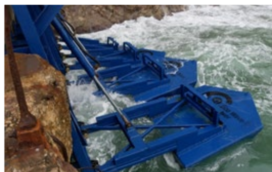
Figur: Ett kraftverk med en installerad kapacitet om 5 MW består av cirka 300 flottörer.
