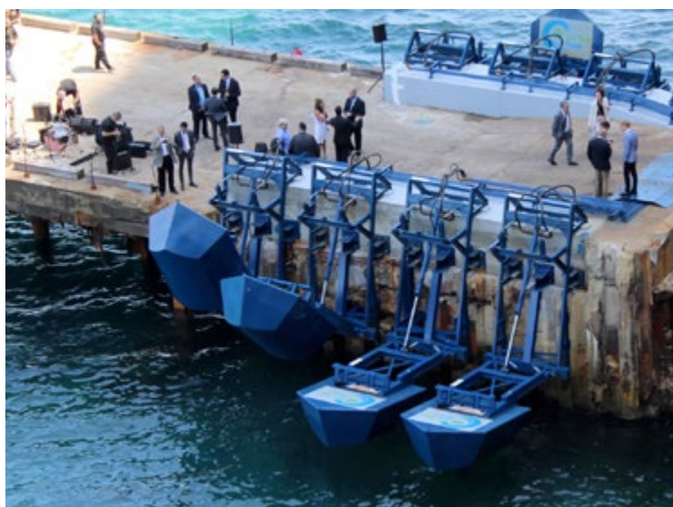
Figur: Ett kraftverk med en installerad kapacitet om 5 MW består av cirka 300 flottörer.
