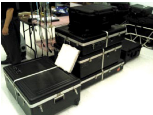
Bild. Fotografiet från 2010 visar Ovzons kompletta prototyp av en platt panelterminal (vit) ovanpå en av kundens befintliga terminaler som bestod av åtta packlådor (s.k. flight cases). Källa: Ovzon.
