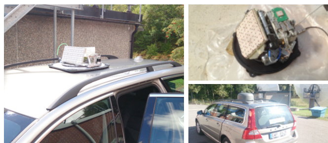
Bild: En Ovzon-modifierad COTM-terminal som under test demonstrerat multi-Mbps i rörelse. Källa: Ovzon.
