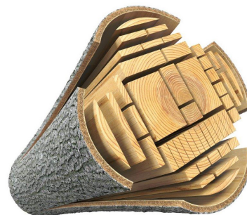
En illustration av hur materialet i en timmerstock kan utnyttjas.
