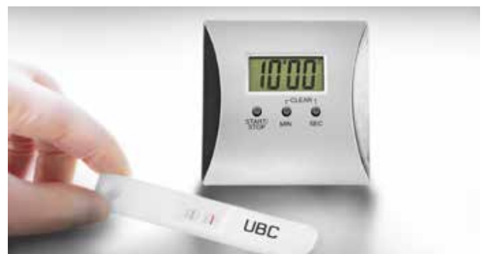
2. Efter tio minuter avläses stickan visuellt. Två streck indikerar positivt resultat. Ett streck indikerar negativt resultat.
