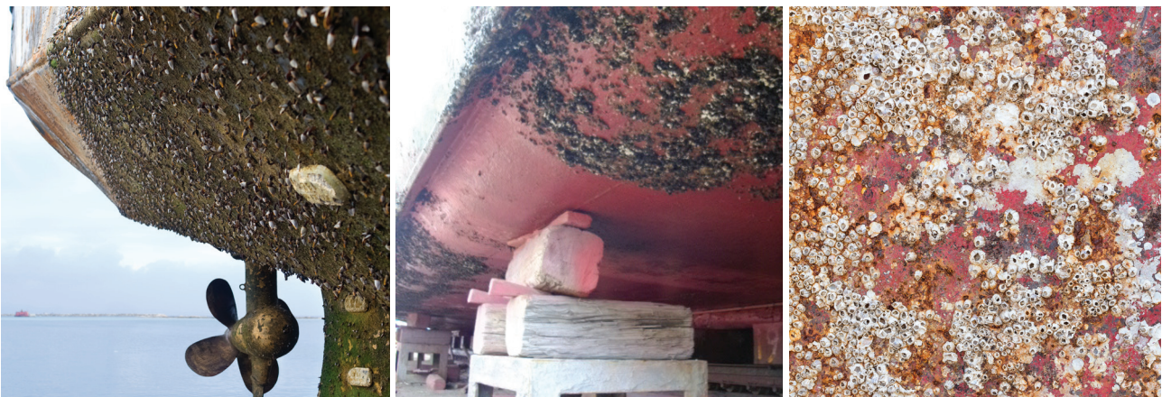
Bilderna visar hård påväxt på fartygsskrov. Den icke bevuxna sektionen på bilden i mitten har målats med Selektope-baserad färg.
