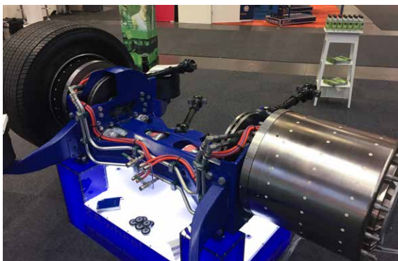
Hybricons bakaxel med monterade elmotorer
