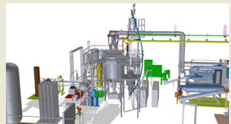
Slutmontage och driftsättning av testanläggningen i Köping om 500 kW syngaseffekt. På bilden ovan syns matningen av biomassa till torken samt hetgasaggregatet.
