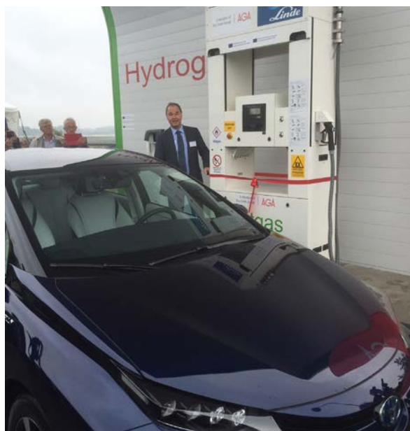
Vätgastankning av bränslecellsbil. En tankning tar 2–3 minuter.
