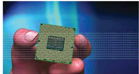
6. Kiselplattan sågas itu till enstaka mikrochip. Ett mikrochip kan idag innehålla ända till miljarder transistorer (elektriska kretsar som kan vara av eller på som mycket små strömbrytare)
