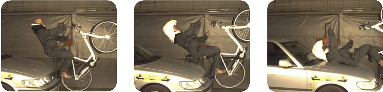
Tusentals cykelolyckor har iscensatts med hjälp av bland annat krockdockor. Ovanstående bildserie visar en krockdocka påkörd bakifrån av en bil. Airbagen fälls ut inom loppet av en tiondels sekund. Eftersom luften stannar kvar ett par sekunder i airbagen skyddar Hövding även vid efterföljande fall mot marken. Traditionella cykelhjälmår går sönder och skyddar betydligt sämre efter första slaget.
