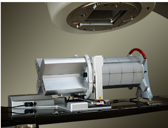
Delta 4 Phantom monterat på HexaMotion
