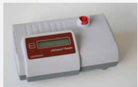
LIFEASSAYS® PRODUKTER UNDER UTVECKLING FÖR PATIENTNÄRA (POC) TESTER LifeAssays® Reader instrument samt tillhörande förbrukningsartikel humant-CRP blodtestkit innehållande 50 blodtest.
