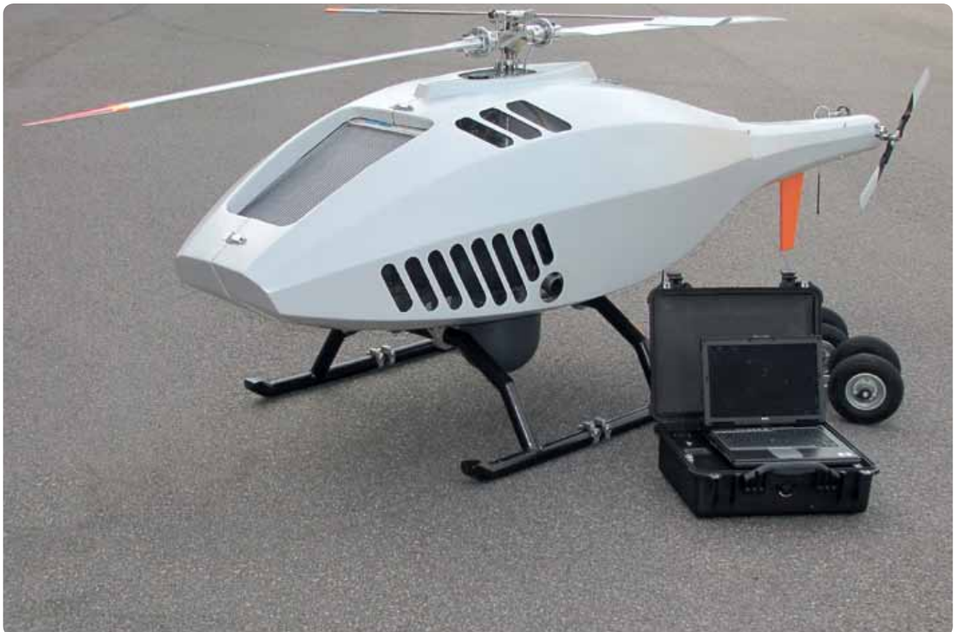
Systembild av de tre huvudkomponenter som ingår i ett system för obemannade helikoptrar. Bilden visar helikoptern, nyttolast i form av kamera (under helikoptern) samt en behändig markstation.
