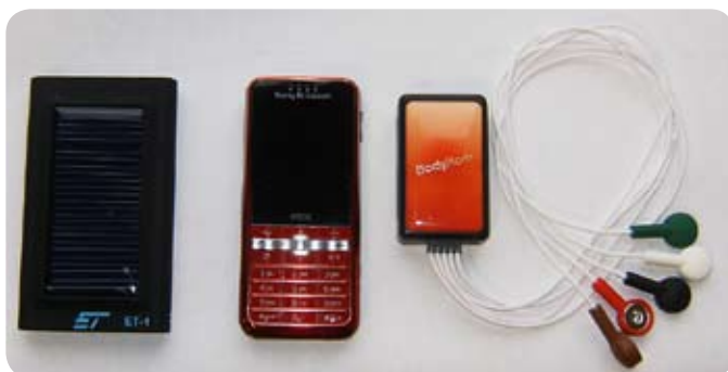
Kommunikationen mellan EKG enheten och omvärlden sker via en vanlig mobiltelefon
