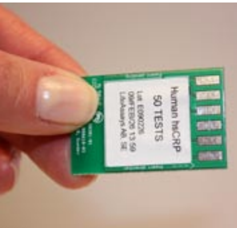
Engångsdatorchip som kvalitetssäkrar och låser instrumentets funktion till testkiten.
